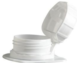
Imagen 2: El cierre UNITED CAPS 23 H-PAK solidario en posición abierta. El tapón se bloquea en posición abierta y permanece alejado de la zona de vertido para facilitar un vertido sin obstáculos. Imagen: UNITED CAPS.
