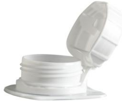
Bild 2: Der UNITED CAPS 23 H-PAK in der Tethered-Ausführung und in geöffneter Position. Der Verschluss rastet in geöffneter Position ein und bleibt außerhalb des Ausgießbereichs, sodass ein ungehindertes Ausgießen möglich ist. Bild: UNITED CAPS.
